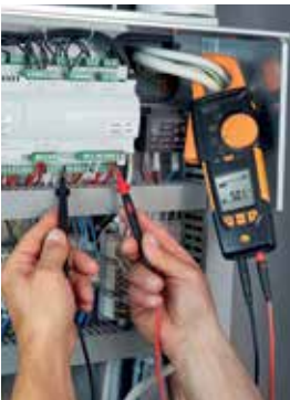
Asılı ölçüm cihazı ile bir ısı pompası şalt dolabında gerilim ölçümü
