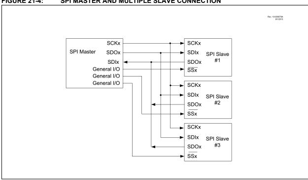
**FIGURE 21-4:** SPI MASTER AND MULTIPLE SLAVE CONNECTION
