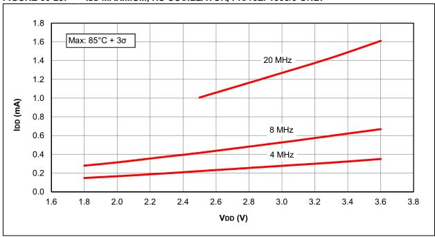
FIGURE 30-29: IDD TYPICAL, HS OSCILLATOR, PIC16F1508/9 ONLY
