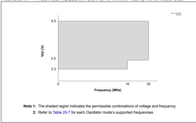
**FIGURE 29-2:** VOLTAGE FREQUENCY GRAPH, -40°C  $\leq$  Ta  $\leq$  +125°C, PIC16LF1508/9 ONLY
