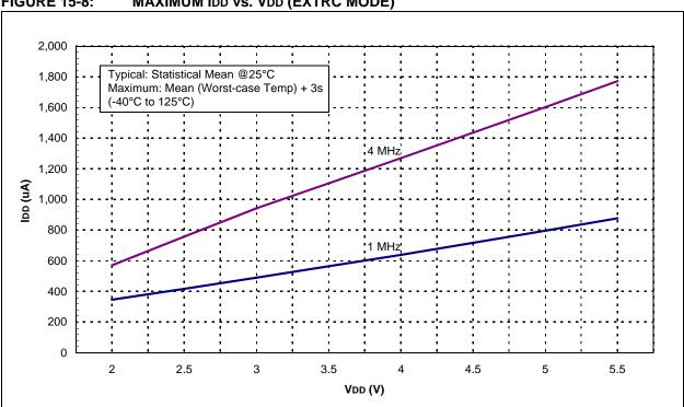
**FIGURE 15-8:** MAXIMUM IDD vs. VDD (EXTRC MODE)
