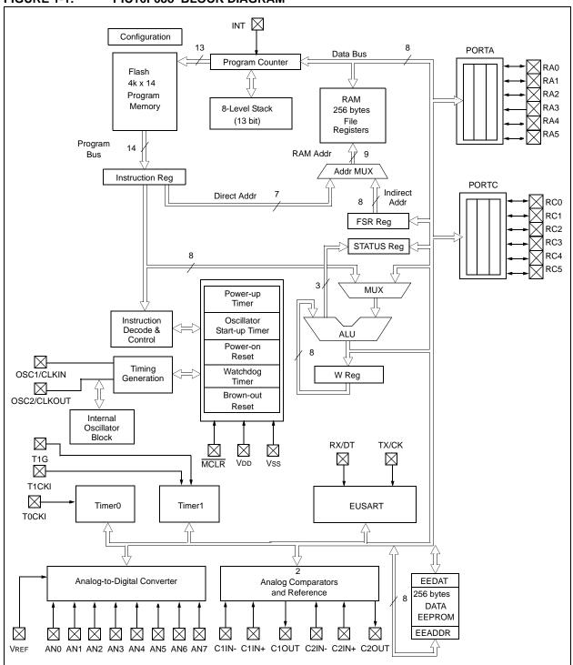
FIGURE 1-1: PIC16F688 BLOCK DIAGRAM
