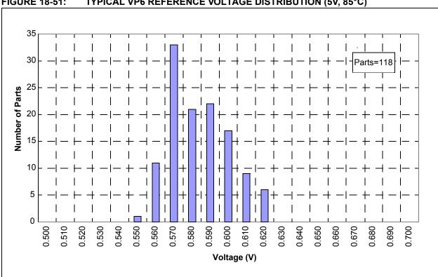
FIGURE 18-51: TYPICAL VP6 REFERENCE VOLTAGE DISTRIBUTION (5V, 85°C)
