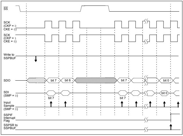
FIGURE 13-4: SLAVE SYNCHRONIZATION WAVEFORM
