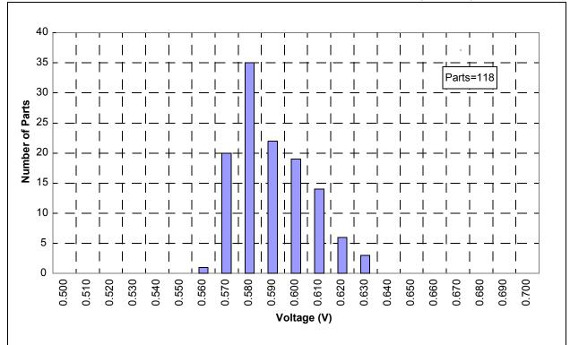
FIGURE 18-47: TYPICAL VP6 REFERENCE VOLTAGE DISTRIBUTION (3V, 85°C)
