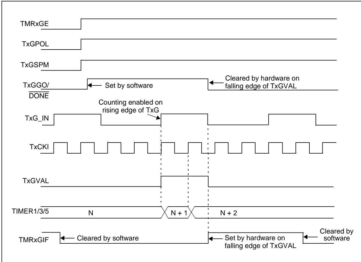
**FIGURE 12-7: TIMER1/3/5 GATE SINGLE-PULSE AND TOGGLE COMBINED MODE**
