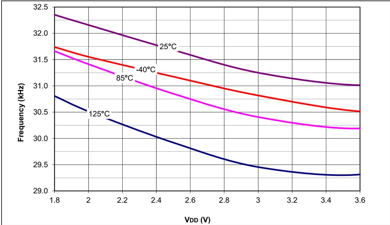
**FIGURE 28-102: PIC18F2X/4XK22 TYPICAL LF-INTOSC FREQUENCY vs. V<sub>DD</sub>**
