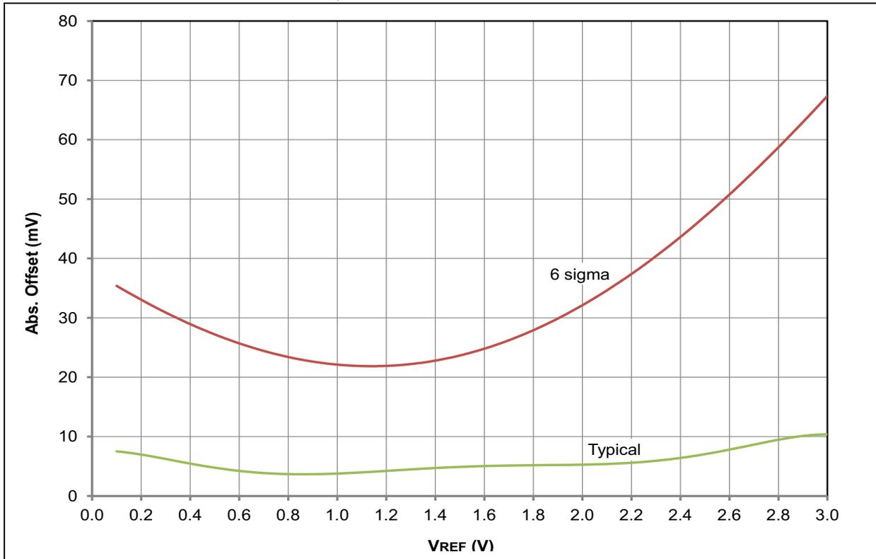
**FIGURE 28-92: PIC18LF2X/4XK22 COMPARATOR OFFSET VOLTAGE, LOW-POWER MODE; V<sub>DD</sub>=1.8V**
