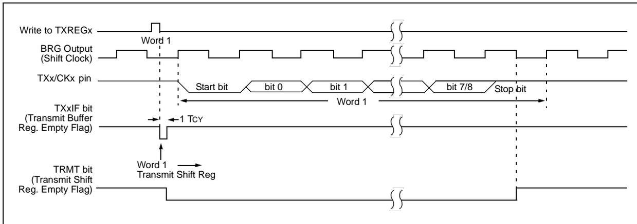
**FIGURE 16-4: ASYNCHRONOUS TRANSMISSION (BACK-TO-BACK)**
