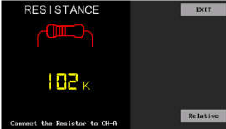
Şekil 20. Kısa devre bulucu modunda 100K direnç ölçümü
