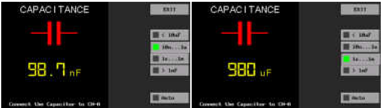
Şekil 16. 100nF ve 1000uF kondansatörlerin manuel modda ölçümü
