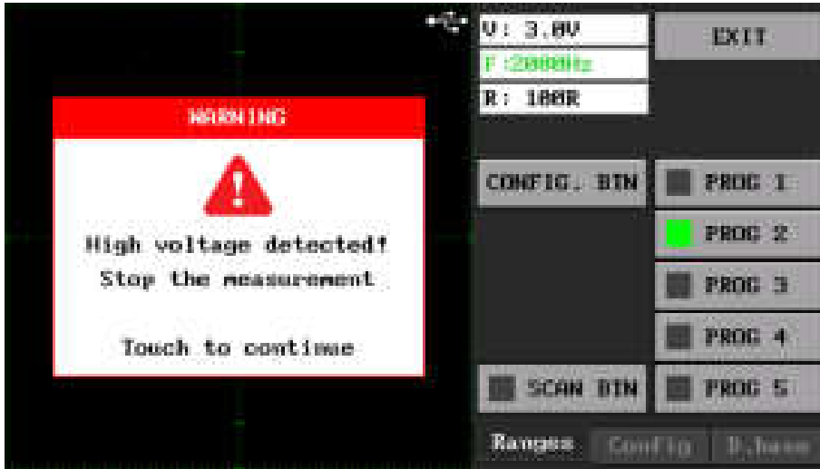
Şekil 11. Yüksek gerilim ölçüm algılanması
