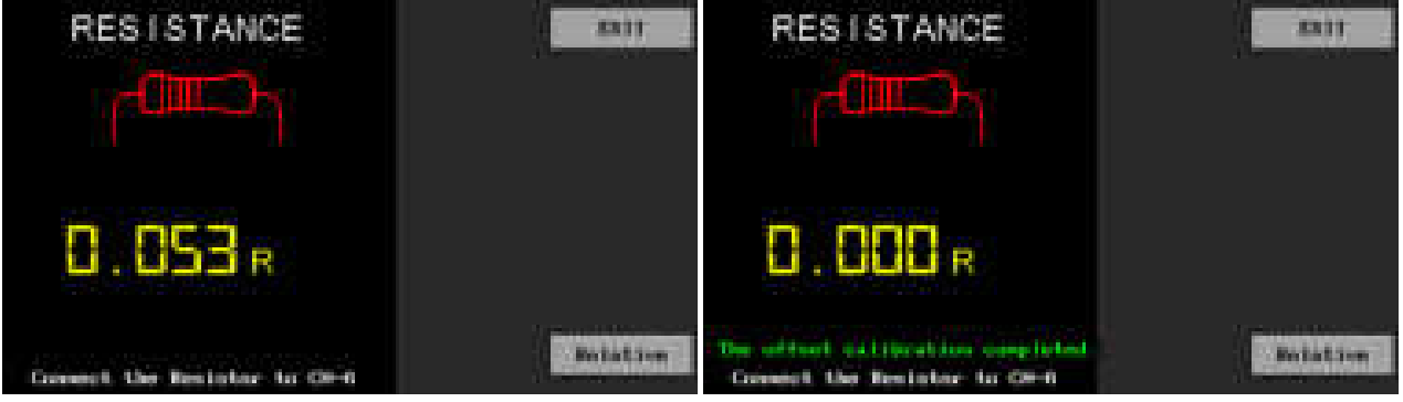
Şekil 19. Kısa devrede ofset kalibrasyonu
