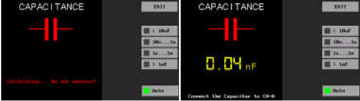
Şekil 15. Kapasitansmetre ana ekranı
