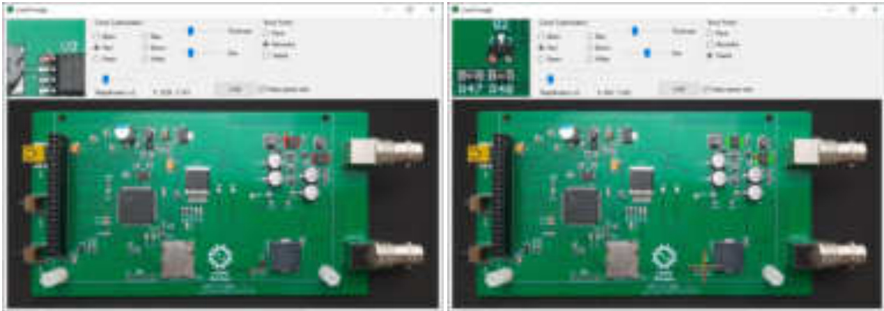
Şekil 32. Görsel yükleme penceresi (kayıt edilen ve test edilen noktaların gösterilmesi)
