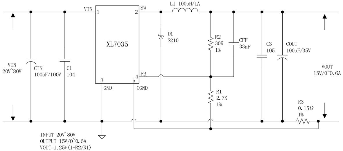
图 7. XL7035 系统参数测量电路 (VIN=20V~80V, VOUT=15V/0.6A)
