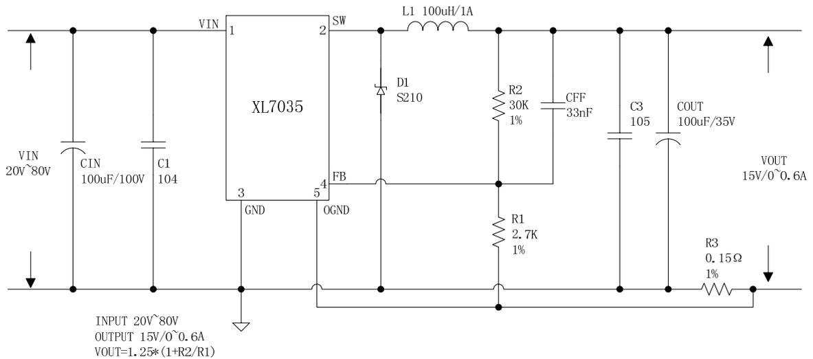
R3 用于限制最大输出电流，当  $V_{OUT} \leq 5V$  时，R3 选择 91 毫欧姆；当  $V_{OUT} > 5V$  时，R3 选择 150 毫欧姆。
