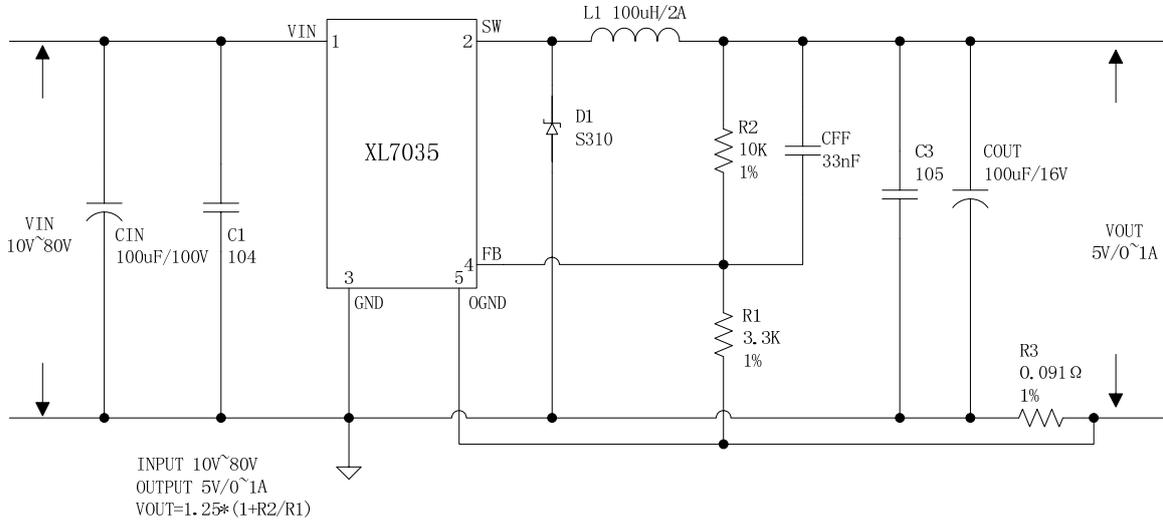
图 9. XL7035 系统参数测量电路(VIN=10V~80V, VOUT=5V/1A)
